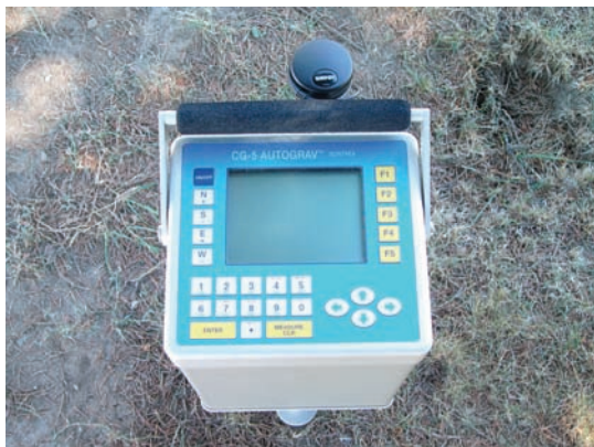
Slika 8. Scintrex-ov CG-5 gravimetar
